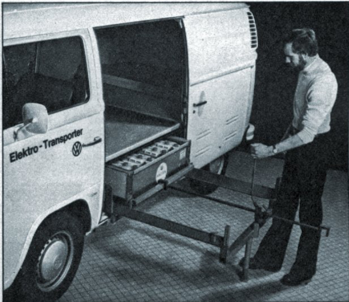
VW-Bus mit Elektroantrieb: Die Kapazität der 850 Kilogramm schweren Bleibatterie reicht für eine Fahrtstrecke von 50 bis 80 Kilometern
